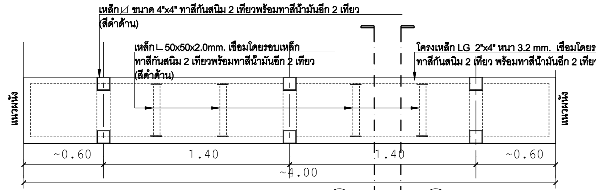
โครงสร้างที่นั่งพักคอยชั้น 2,3 มาตราส่วน 1 : 25
