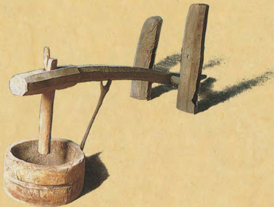
กรรกระเดื่อง ใช้ตำข้าวเปลือกให้เป็นข้าวสาร
